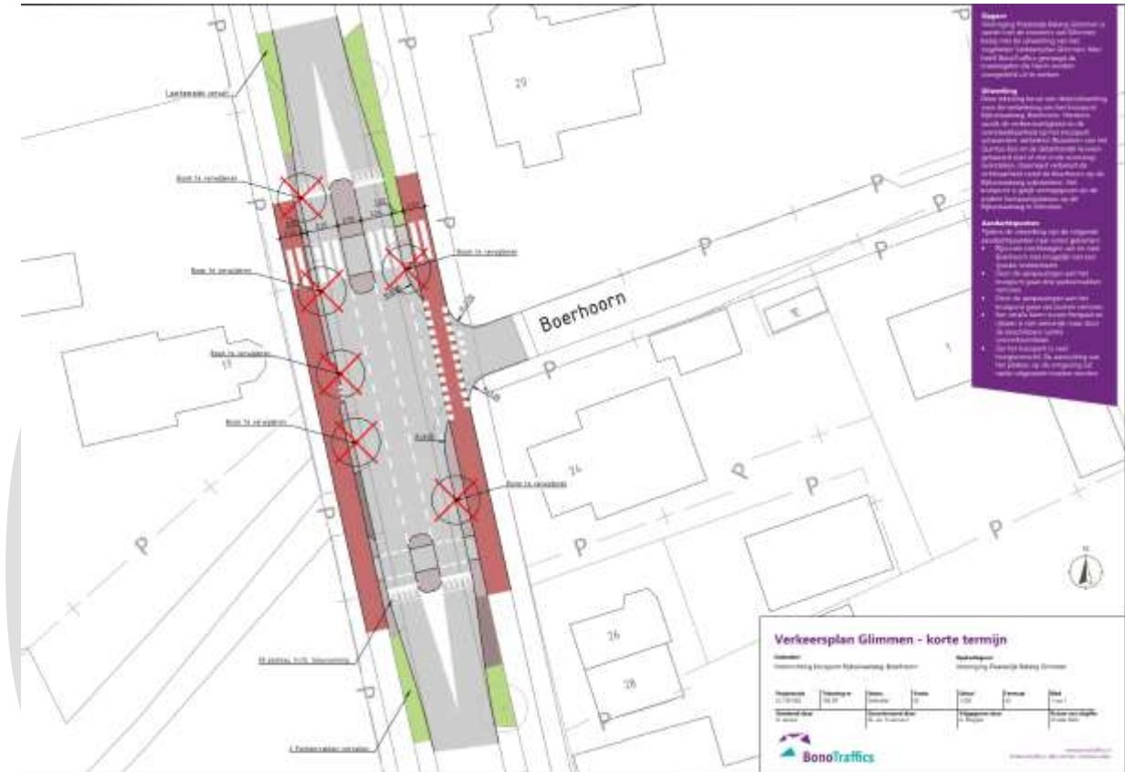
220523 - PB Glimmen - verkeersplan Glimmen - kruispunt Rijksstraatweg-Boerhoorn (korte termijn): een ingezoomd schetsontwerp van de herinrichting van het kruispunt Rijksstraatweg-Boerhoorn.
